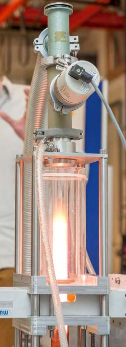
Het kokertje met plasma waarin CO 2 wordt omgezet in CO.
