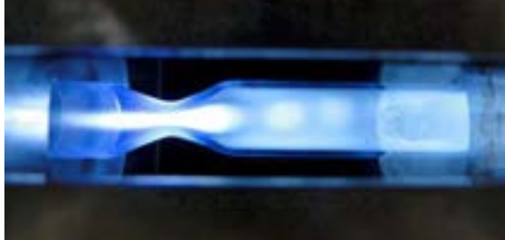
Het kokertje met plasma waarin CO 2 wordt omgezet in CO.
