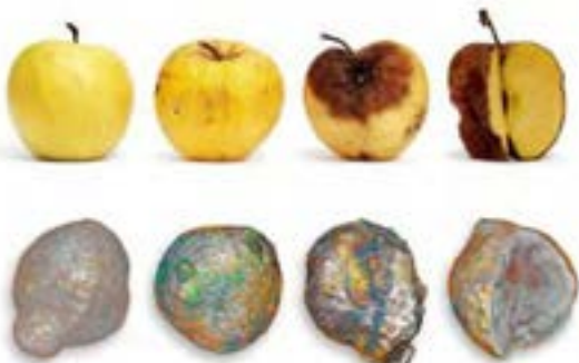
Bovenaan: bij een appel gaat de rot van buiten naar binnen. Onder is te zien dat een katalysatordeeltje ook eerst van buiten vergiftigd raakt.
